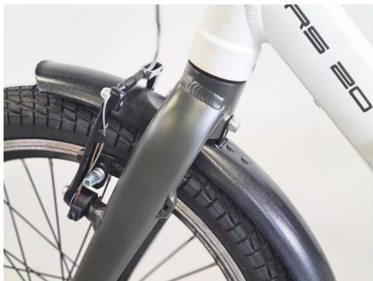
Vorderes Schutzblech mit Inbusschraube M6 x 60, Beilagscheibe und Mutter an der Gabel anbringen (Befestigungsblech an der hinteren Seite der Gabel).
