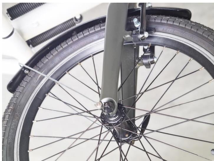
Vorderen Befestigungsbügel mit Kreuzschlitzschrauben an der Gabel (siehe Bild),
